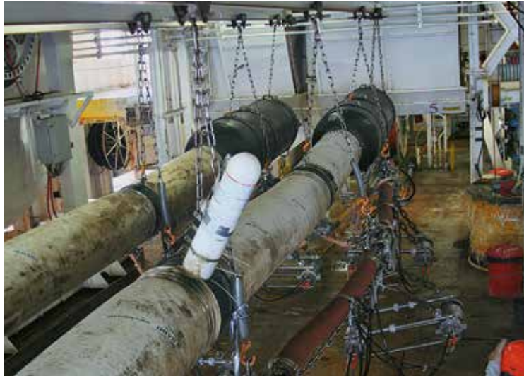
Bộ thu tín hiệu địa chấn «Seismokosa» sử dụng trong nghiên cứu thêm lục địa bằng phương pháp địa chấn
